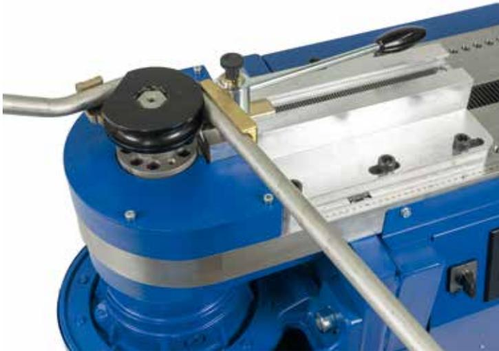
Adaptersystem mit Sechskantwelle zur Verwendung der Werkzeuge aus der Modellreihe 3000 und 6000.
