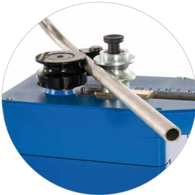
**Einfach, schnell und schonend für Material und Maschine - Biegen mit Gegenrolle.**
